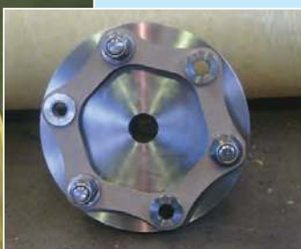
带防磨和防腐涂层的 AISI301碟片组
