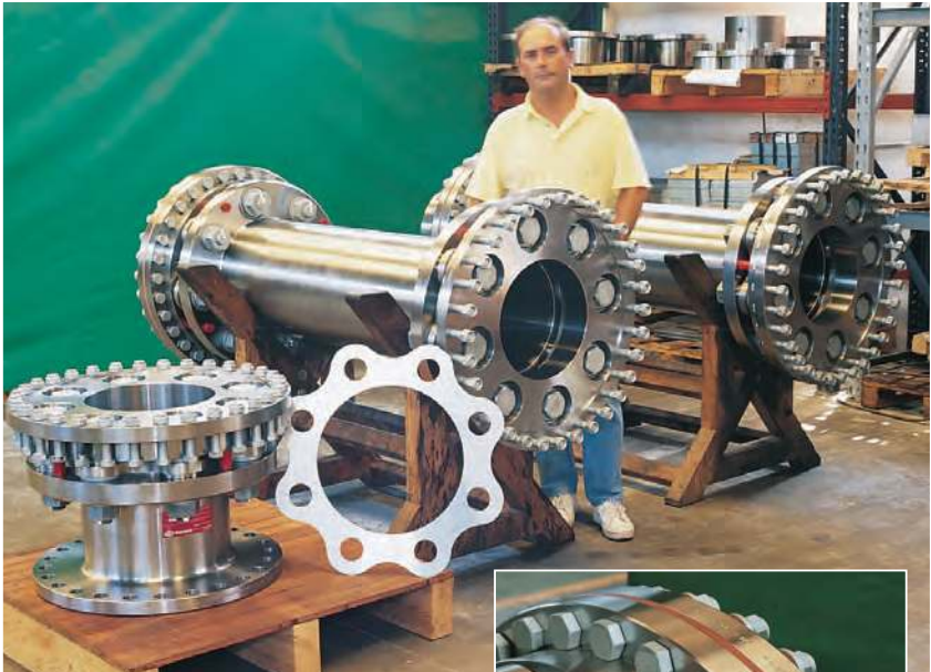
Lamidisc® DO-675-8 SP用于海洋船舶推进（喷水式推进器）
