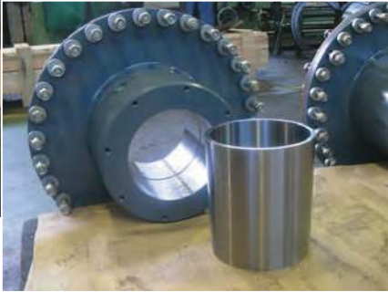
用于液压拆卸的锥形齿圈
