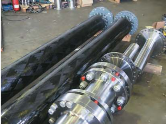
Lamidisc® DOAE-475-8-CFRP: 用于快速轮渡轴系
