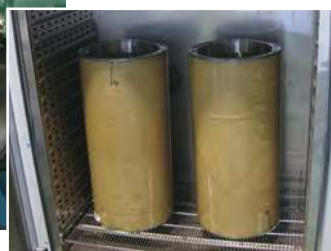
用于液压拆装的圆锥套管
