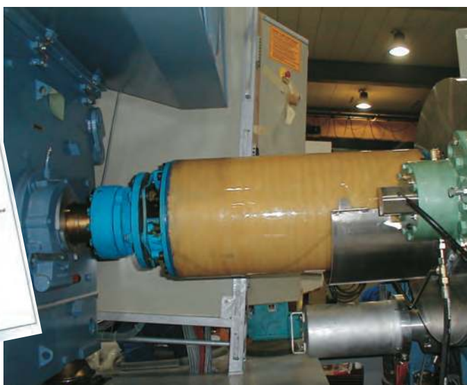
用于风机的带玻璃纤维轴的碟片组SXGF-302-6/752mm
